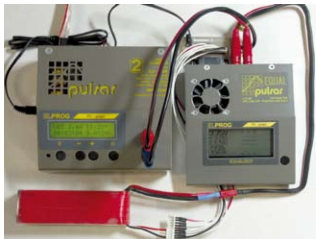
Die Symbiose ist hier am Beispiel eines 3s-Lipo-Packs komplett verkabelt
